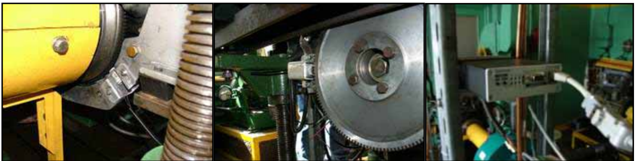
Fot. 1. Czujniki reluktancyjne współpracujące z kołami zębatymi na przeciwległych końcach wału korbowego oraz moduł pomiarowy DTS 700 przetwarzający sygnał
